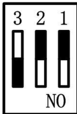
启动配置开关模式配置图（从 TF 卡中启动）
